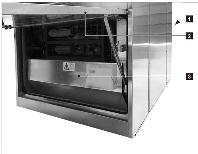
Imaginea 13: În momentul livrării, tabla de protecție a ventilatorului este fixată provizoriu cu 4 șuruburi.
